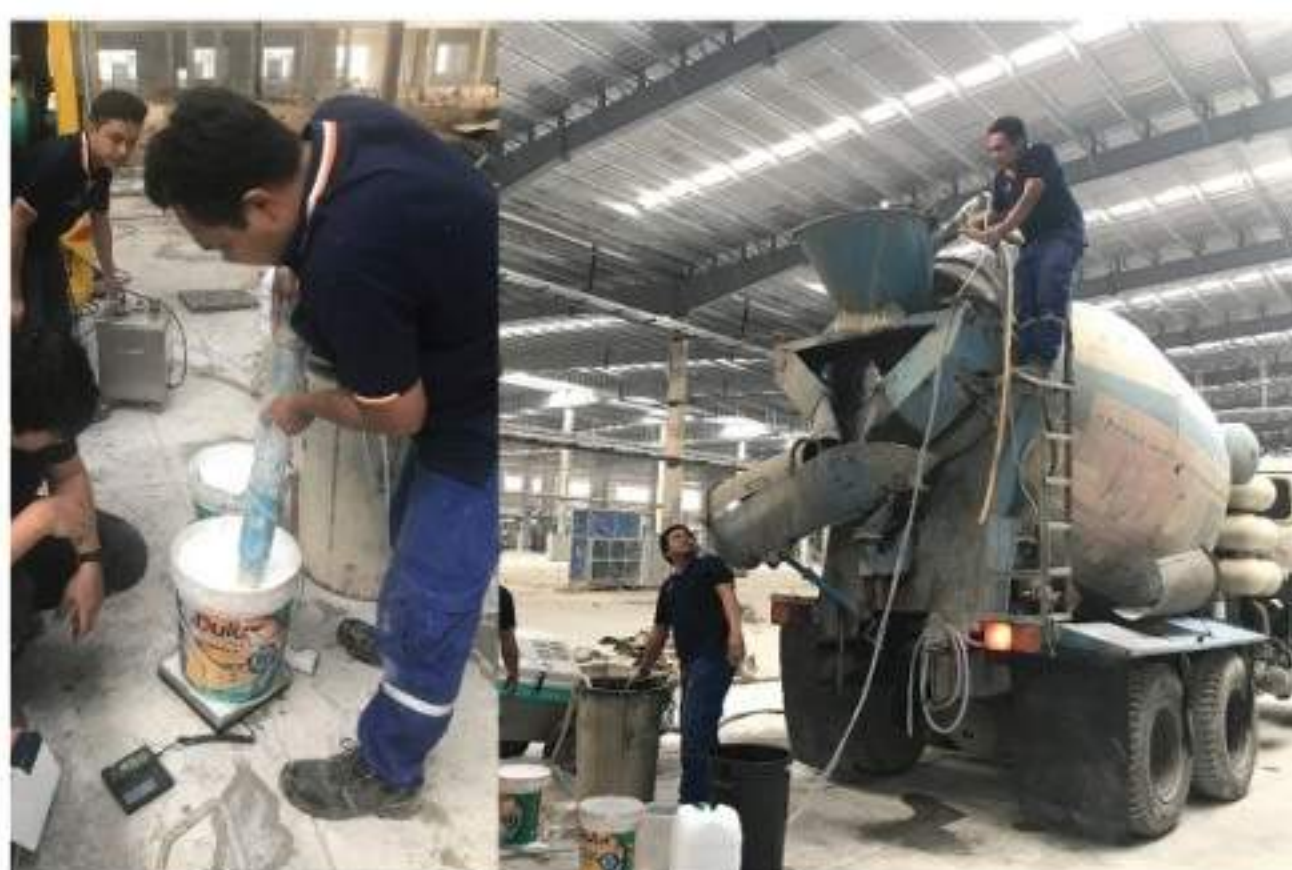
การผสมซีเมนต์เฟสท์และฟองโฟม ฟองโฟมจากเครื่อง ผลิตโฟมจะถูกผสมเข้ากับซีเมนต์ตามอัตราส่วน โดย อัตราส่วนผสมจะขึ้นอยู่กับลักษณะการใช้งานของพื้นที่ และความแข็งแรงของวัสดุ (Compressive Strength) ที่ต้องการ ทุกกระบวนการจะมีการตรวจสอบคุณสมบัติ ของฟองโฟมและซีเมนต์เฟสท์
